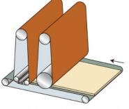
■コンピュータ制御分割自動パッド装置 すべての端面に働く端ダレ防止機構で前後はもちろん 左右の端ダレまで防止。
